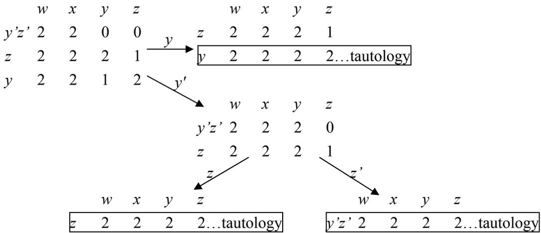
全部都 tautology，表示  $G_{w'x}$  為 tautology，故  $w'xy$  可 expand 為  $w'x$ ，讓  $G' = w'y'z' + xz + x'yz' + w'x$ 。又在先前的測試中，已知  $w'xy$  不可往  $w$  或  $x$  方向 expand，而  $w'x$  包含  $w'xy$ ，比  $w'xy$  更大，故更無法往這兩方向 expand，可推得  $w'x$  為 prime。
